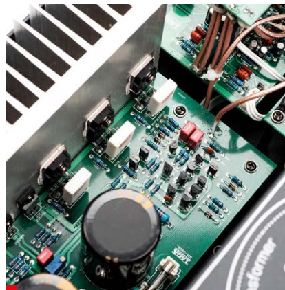
Tor sygnałowy jest dyskretny, wykonany na bazie tranzystorów bipolarnych, ale także fetów.
