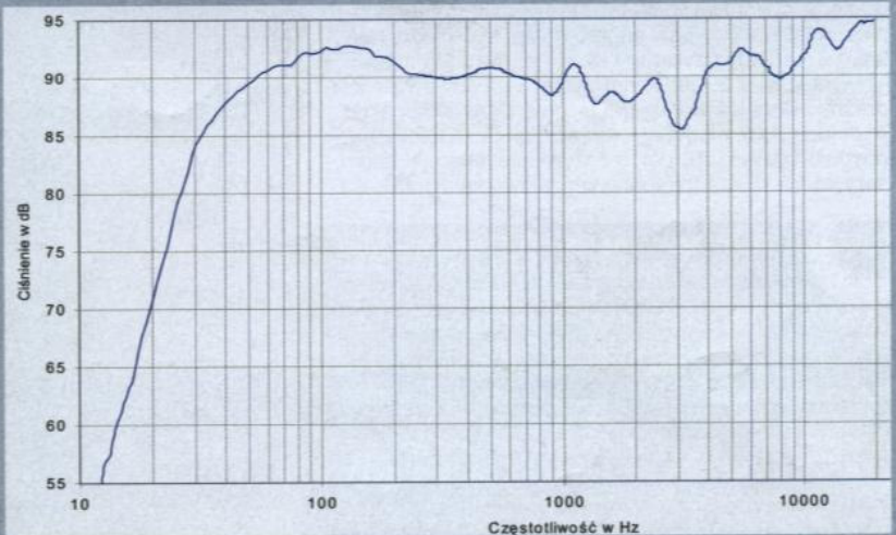
rys. 4. Charakterystyka przetwarzania w całym pasmie akustycznym, złożona z pomiarów sinusoid i MLS.
