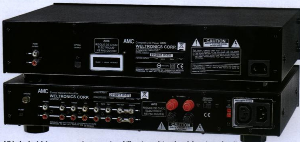
Układ tylnej ściany wzmacniacza zawiera kilka niespodzianek: selektor impedancji, wejście na końcówki mocy oraz wyjście z przedwzmacniacza spięte zworą, jest też nietypowe gniazdo sieciowe do podłączenia kolejnego urządzenia - np. odtwarzacza.
