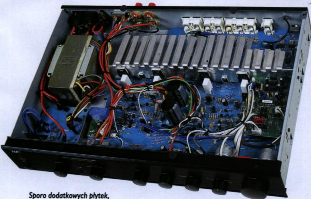
Układ selekcji wejść jest niezwykły - potencjometr z silniczkiem działa na zasadzie detekcji położenia, aktywując umieszczone dalej przełączniki.
