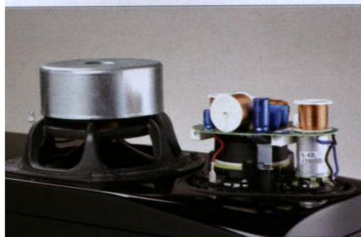
Płytkę ze zwrotnicą modułu średniowysokotonowego znalazła się w bezpośrednim sąsiedztwie głośników
