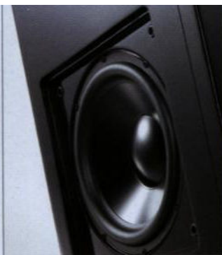
Duży głośnik basowy zamocowano na ścianie bocznej. Można go zasłonić maskownicą
