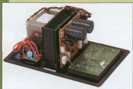
Tylna ścianka subwoofera od strony wewnętrznej. 150-watowy wzmacniacz jest bardzo przypoitej jakości
